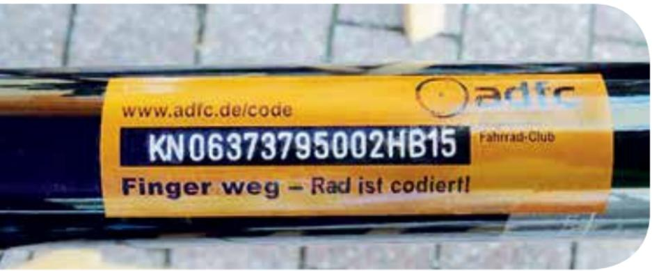
Die Codierung mit dem Nadelpräegerät wird in der Regel auf der rechten Fahrradseite am Sattelrohr angebracht. Dort störende Gegenstände wie Kindersitz, Schlosshalterungen oder der Akku müssen gegebenenfalls zur Codierung abmontiert werden. Deshalb ist der Pitlock- und Akkuschlüssel mitzubringen.
